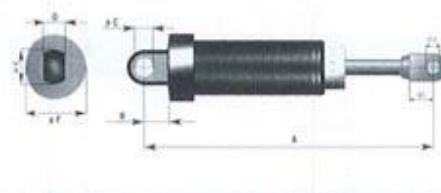
Montagem oscilante FA-MSP 1,25 ... 2,0 Montage oscilante / Clevis mounting
